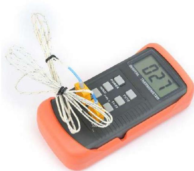
شكل (4 - 5) جهاز ازدواج حراري رقمي
