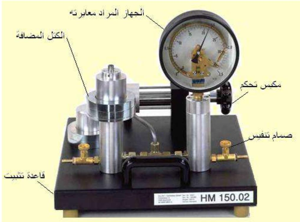
شكل ( 5 - 7 ) جهاز المعايرة بالحمل الميت
