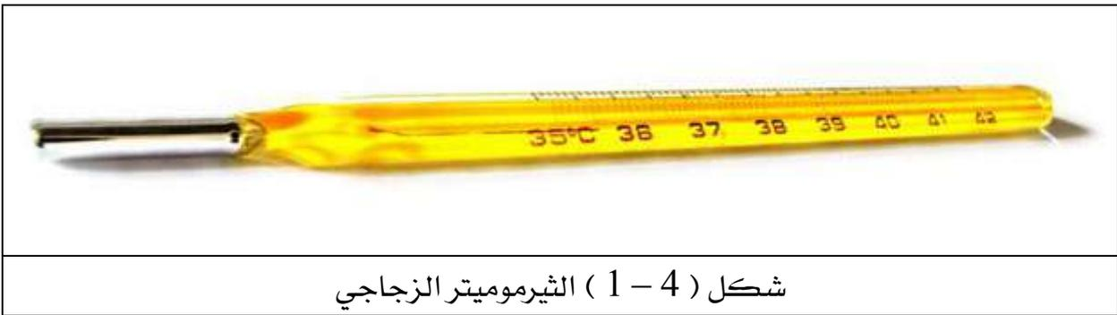
ويعتبر الترمومتر الزئبقي في الزجاج أكثر الترمومترات استعمالاً لقياس درجة الحرارة - ويتكون من فقاعة زجاجية تحتوي على كمية من الزئبق، وساق مصنوعة من أنبوبة سميكة الجدران وبها مجرى شعيري و الحد الأدنى لقراءة الترمومتر هي نقطه تجمد الزئبق وهي حوالي 38.3م.
