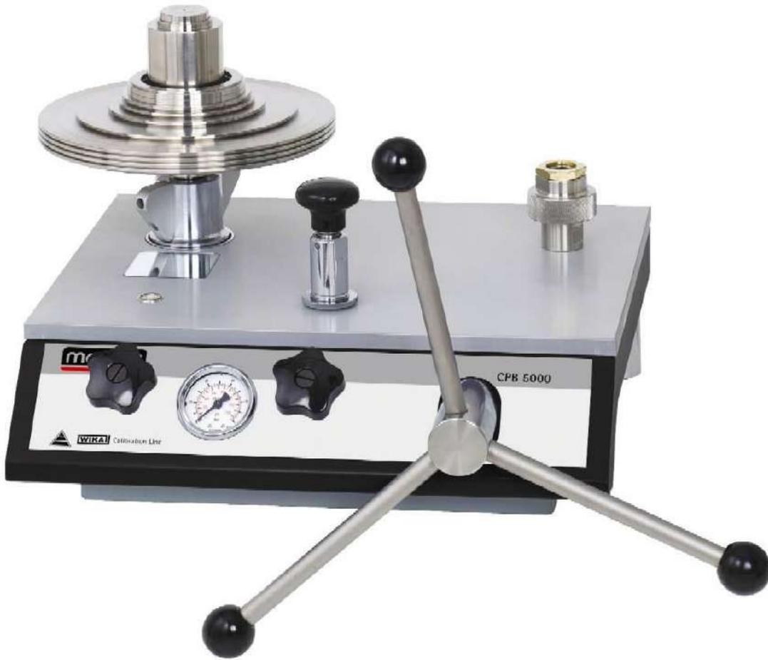
شكل (1 - 2) جهاز المعايرة بالحمل الميت
