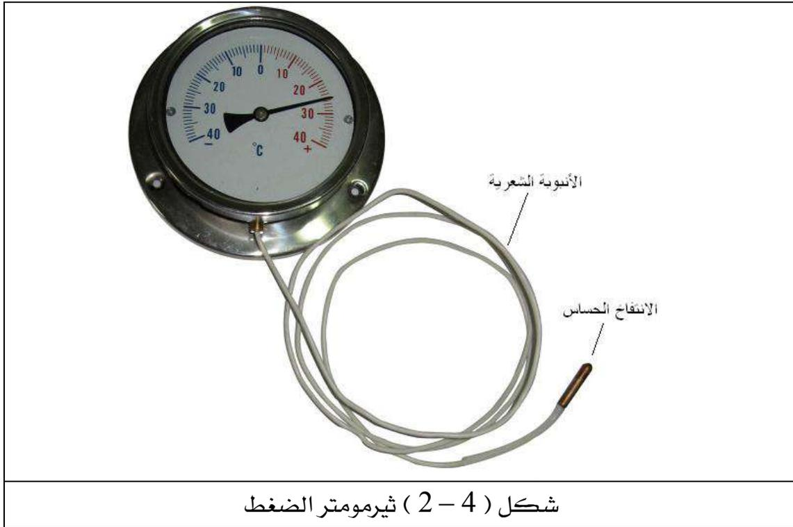
وفي التصميم العام، توضع المادة المائعة في فقاعة، وتوضع هذه الفقاعة في المائع المراد قراءة درجة حرارته، وتصل أنبوبة شعرية مابين الفقاعة وجهاز قياس الضغط الذي يكون مدرجاً بحيث يقرأ درجات الحرارة.
